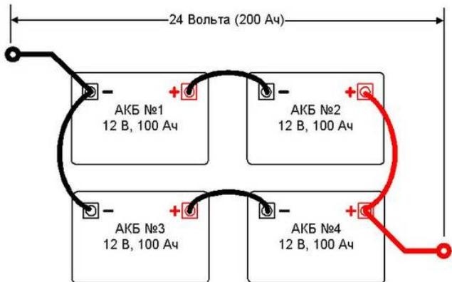
При параллельном соединении важно подключать нагрузку "по диагонали", как это видно на рисунке выше. Такое подключение совместно с применением перемычек одинаковой длины позволит сбалансировать зарядные и разрядные токи каждого аккумулятора
